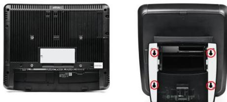
Пожалуйста, найдите четыре отверстия в верхней части подставки. Возьмите подставку и сопоставьте эти четыре отверстия с четырьмя соответствующими штырями, находящимися на обратной стороне терминала.
